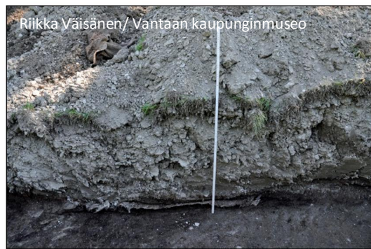
Kuva 12 ja 13: Koeojan 3 eteläpäädyn itäprofiilissa erottuivat parhaimmillaan yli metrin paksuiset savitäyttökerrokset. Vasemmassa kuvassa 12 saven alla muovirokia, ja oikealla kuvassa 13 suodatinkangas. Kuvat on otettu itään.
