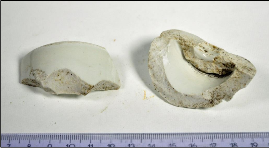
Posliinisia sähköeristeen katkelmia.
