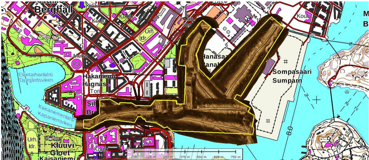
Kartta 7. Mosaiikkikuva viistokaikuluotauksen kattavuudesta tutkimusalueella. Tutkittavat alueet on rajattu karttaan keltaisella. Karttapohja MML.
