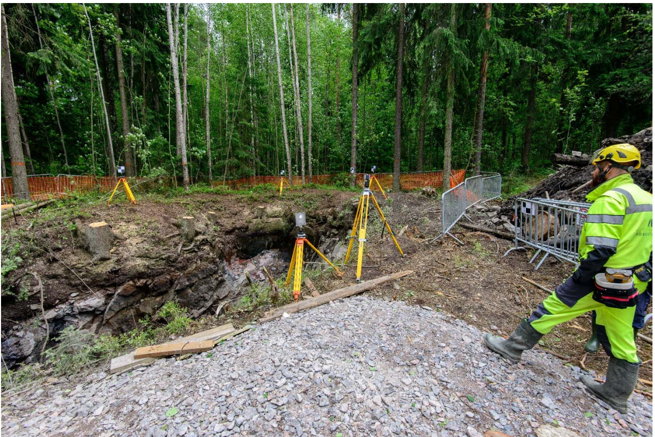
Kuva 5. Laserkeilaus kuopan laidalta käynnissä. Kuvassa Janne Hymylä. Kuva: Vesa Laulumaa/ARKE (AKDG4910:19).
