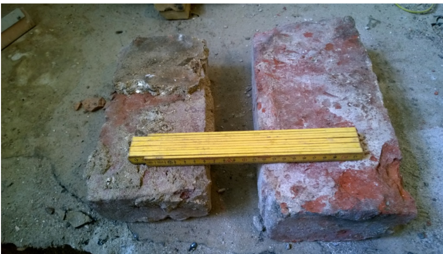
AKDG 5108:4. Lattiassa on käytetty ainakin kahdenkokoisia tiiliä, a) 295 x 145 mm ja b) 245 x 120 mm. Kuvaaja: Petro Pesonen.
