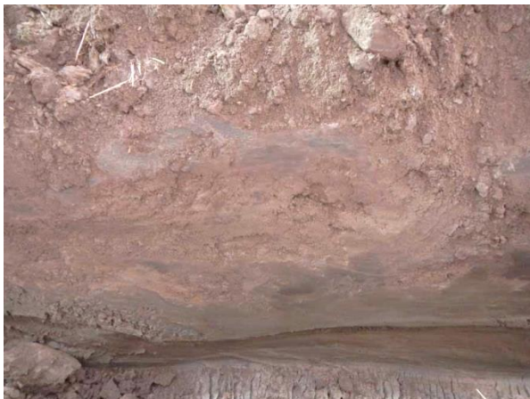
Kuva 7. Kaivannon maannos koostui sen itäosassa hienosta hiekasta. Pohjamaannos oli hiesua/hiesusavea. (Kuva: Ulvilan kirkko 2016:4)
