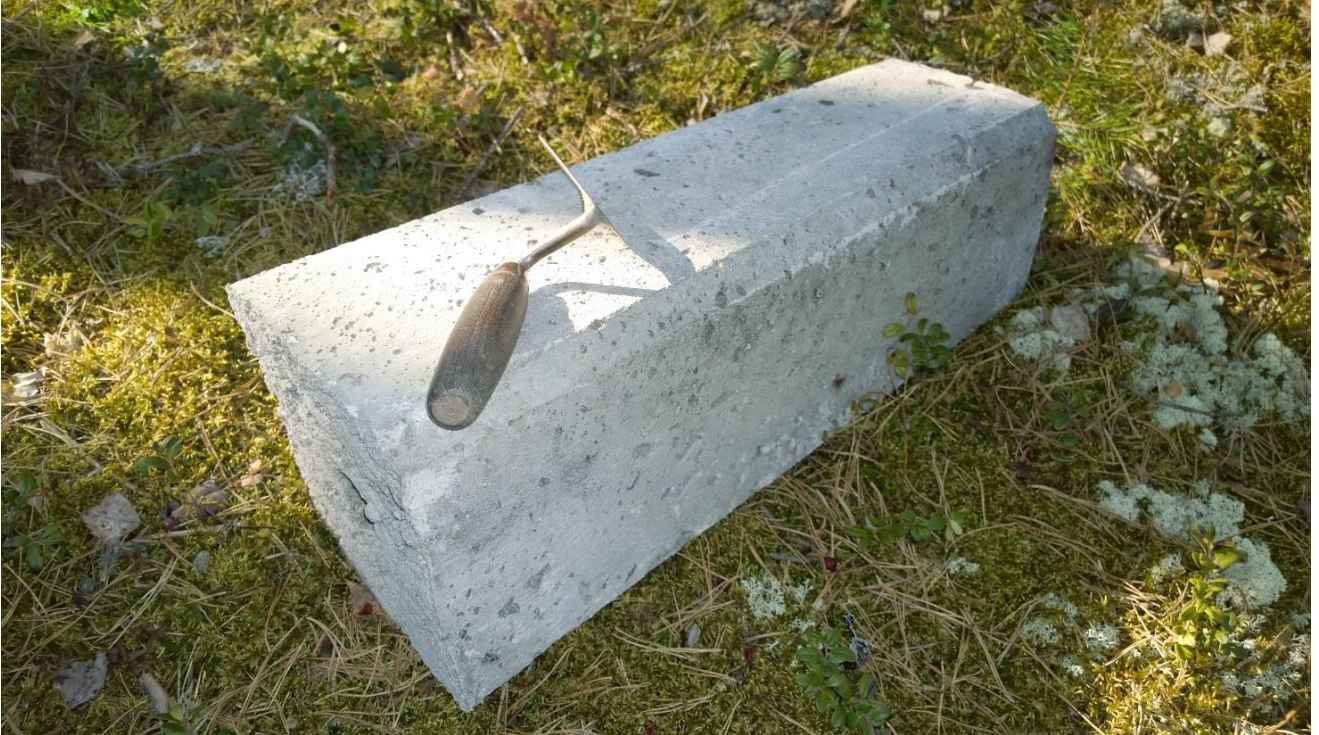
Kuva 5. Kuoppaan sovitettiin opasteen tai maalikorin asennusputken jalustaksi betoninen kartio, jota ei tarvinnut kapean kuopan vuoksi erikseen sementoida paikalleen. Kuva: Satu Koivisto/ARKE (AKDG 5037:5).
