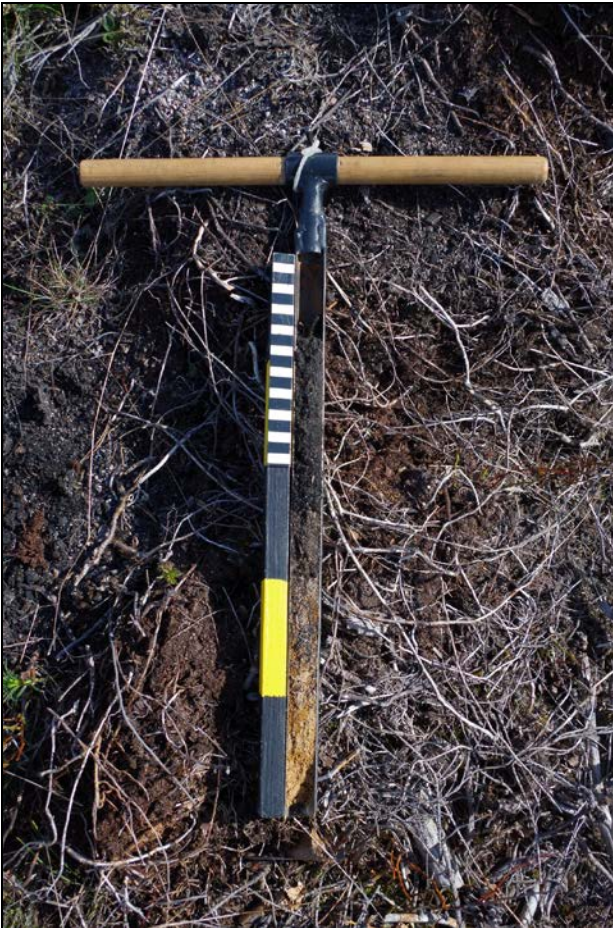
Kuva 7: Kairausnäyte miilu M1:n kohdalta. Steriilin pohjamaan päällä sijaitti 30 cm:n paksuinen hiili- ja nokimaakerros. Kuva: KyM/M. Kykyri.
