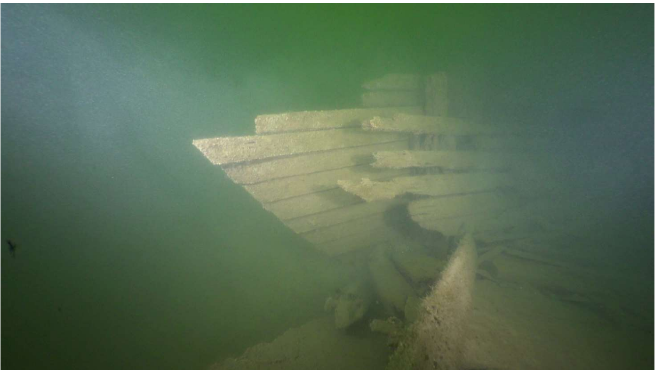
Kuva 2. Keula sisäpuolelta: styyrpuurin puolen kulunutta sisäkarneerausta.
