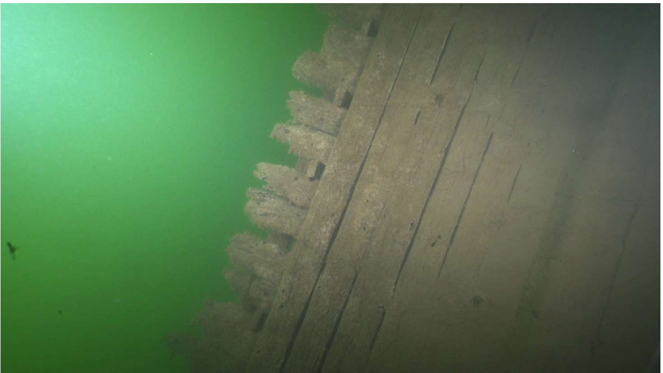
Kuva 12. Parikaaria (2 x 17 cm) ja sisäkarneerausta paapuurin puolella keskilaivassa. Parikaarien väleissä (16 cm) näkyvät suolahyllyt paikoillaan.
