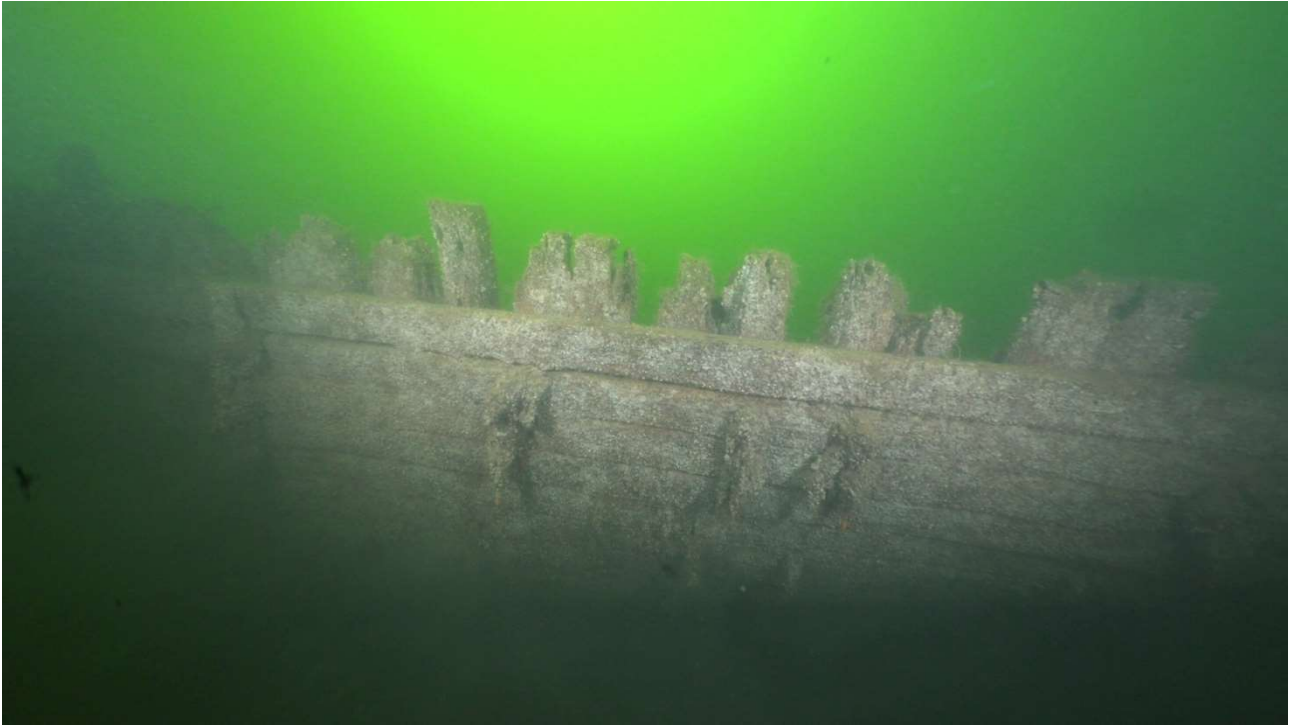
Kuva 13. Taemmat rustiraudat paapuurin puolen kyljessä. Parikaarten ylimmät osat ovat erittäin kuluneet.
