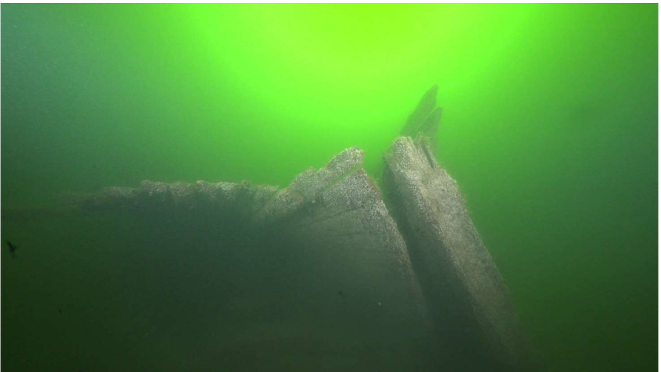
Kuva 8. Perä paapuurin puolelta kuvattuna. Paapuurin puolen kylki on perässä auennut tasoon, jonka alta dokumentointi ei ollut mahdollista.
