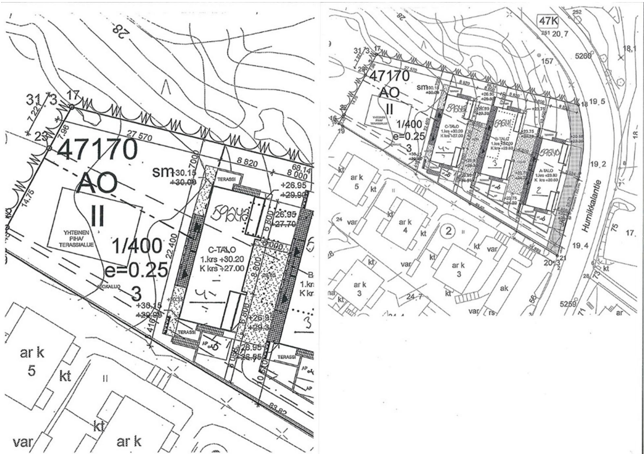
Kolmen rakennuksen suunnitelma tontin keski- ja itäpuoliskoon. Läntisimmän talon (C-talo) perustuksen teon takia tarvittiin kalliolouhintaa sm-alueella noin kahden metrin leveydeltä.
