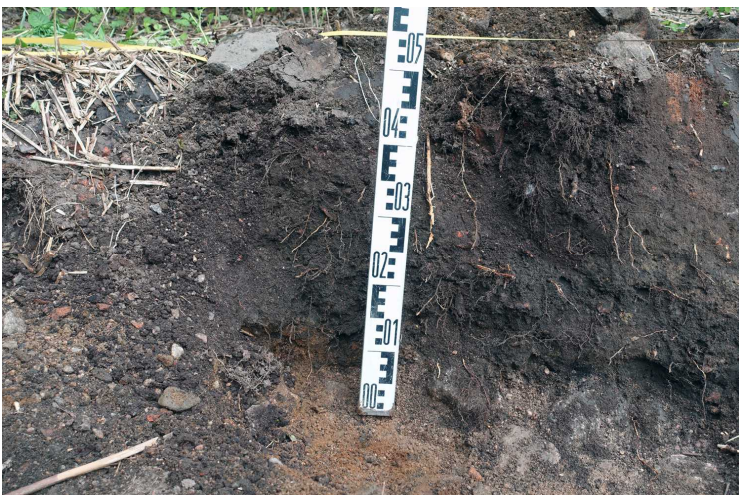
Kuva 76. Rakennus, havaintopiste R3. Profiilissa oli käytännössä yksi kerros ennen moreenia. Kuvaussuunta ENE. 17.5.2016.
