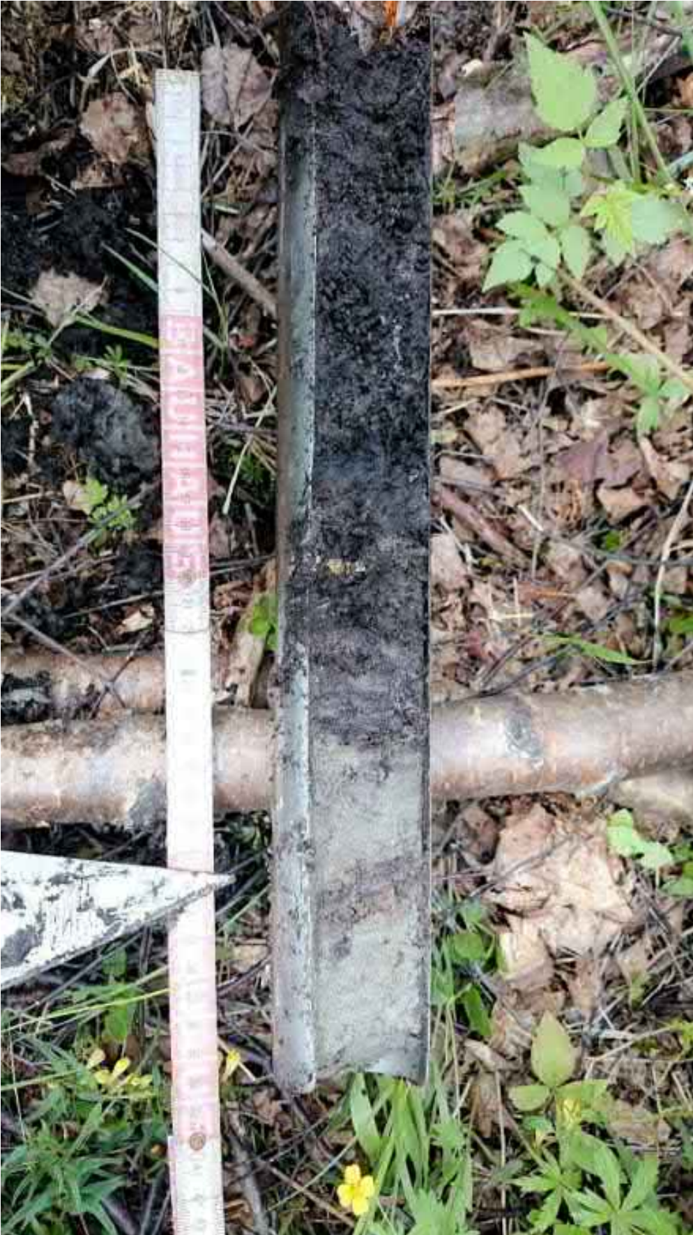
Taipalsaari Ketvele. Kairauspiste 13. Vetistä turvetta ja silttiä, siltissä tumma orgaaninen kerros.
