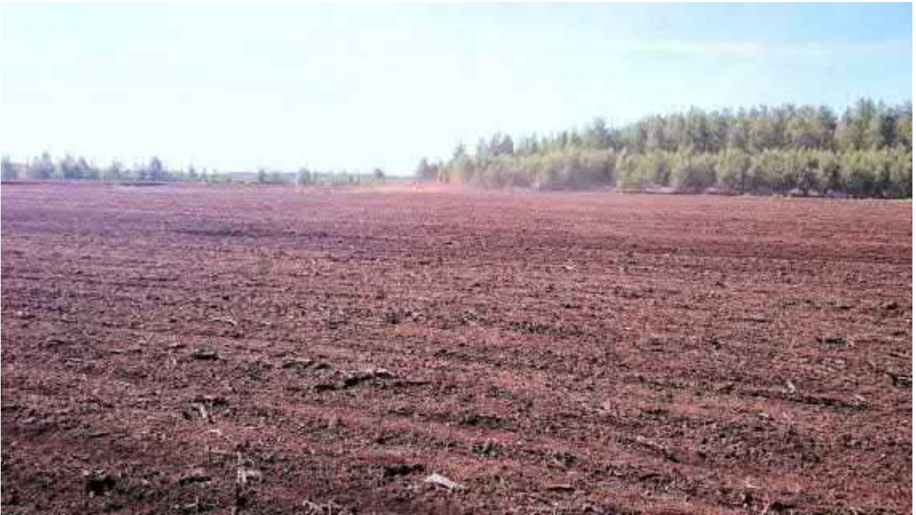
Kuva 10. Turvetuotantoalueiden inventointi aloitettiin LIL-projektissa Saimaan rannalla sijaitsevalla Taipalsaaren Suursuolla. Turvekerrosta jyrsitään ohuina, vain muutaman sentin kerroksina kesäisin, jätetään kuivumaan ja korjataan. Yhden kesän aikana turvetta poistetaan vain muutamia kymmeniä senttimetrejä tuotantolohkoittain. Kuva: Satu Koivisto.
