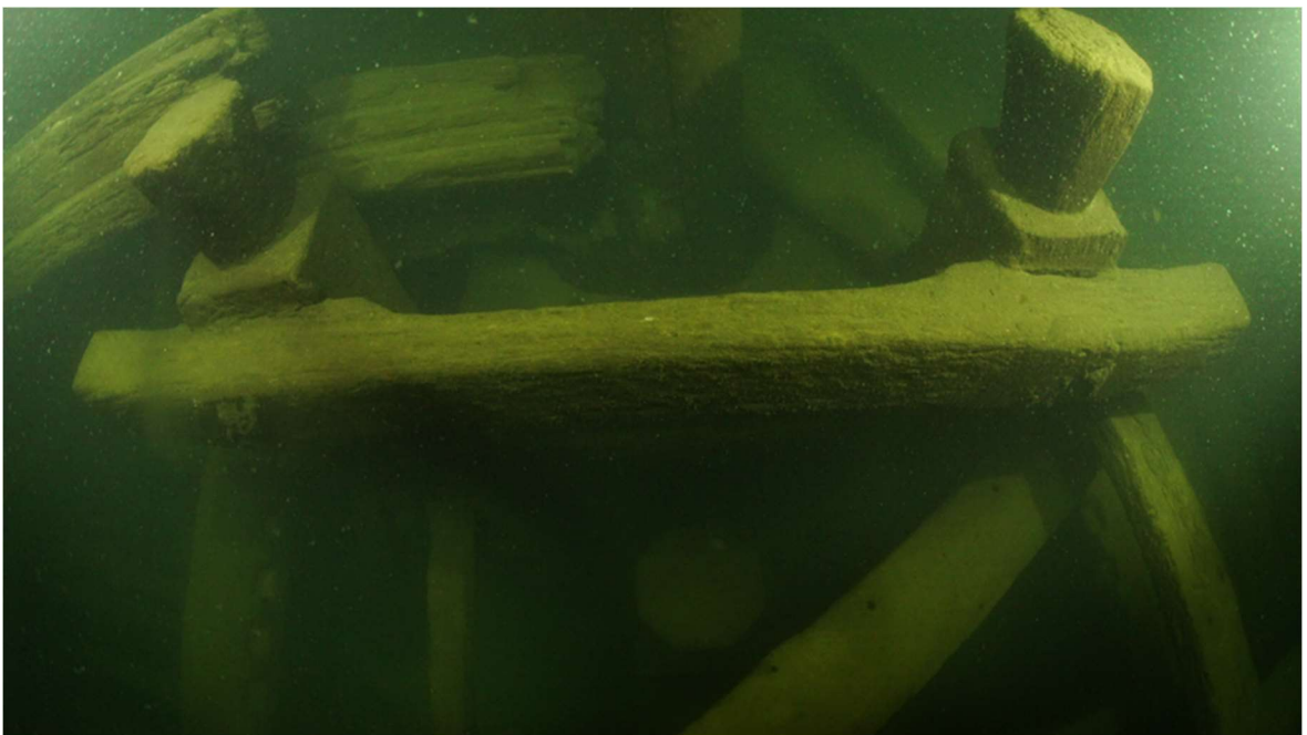
Fig. 40. Pollarit (Jeerbitts) isomaston takana. Ruutukaappaus videosta: Kari Hyttinen.
