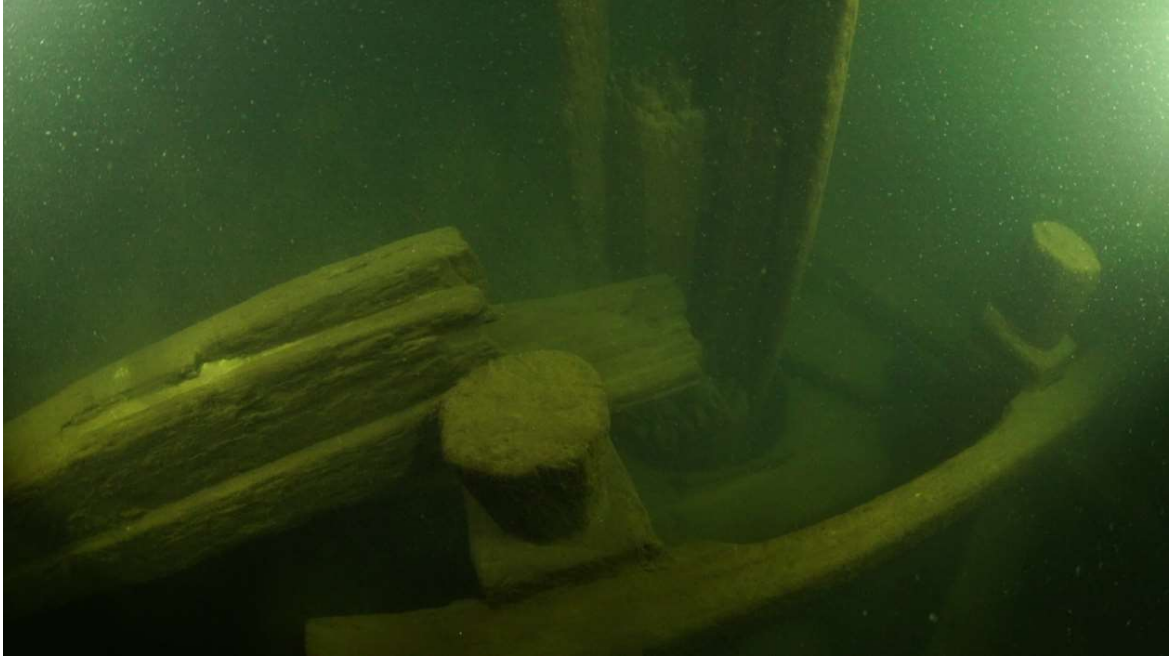
Kuva 39. Pollarit (Jeerbitts) isomaston takana, jossa näkyy kahdeksankulmaiset pystytolppien päät. Ruutukaappaus videosta: Kari Hyttinen.
