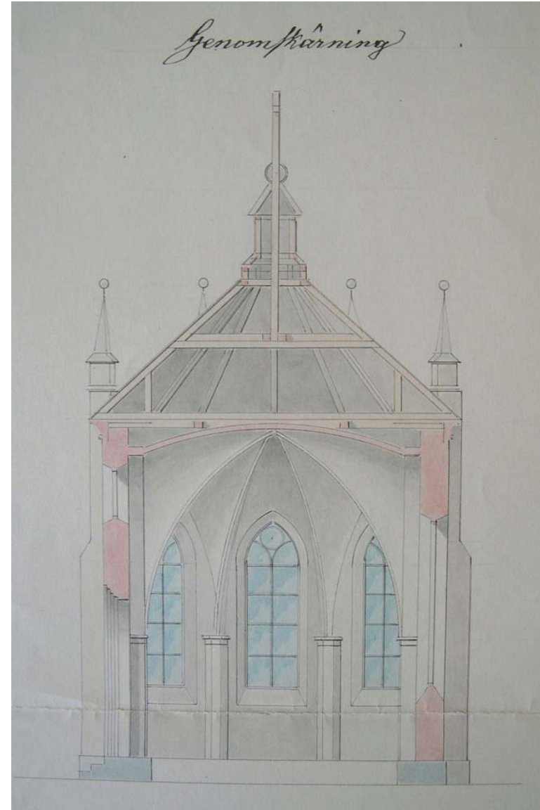
Leikkauspiirustuksessa tornit on piirretty oikein, mutta holvikaarien alapäässä olevat konsolit on piirretty väärin. Gylichin muissa piirustuksissa on piirretty malli sellaisia konsoleita varten, jotka kappeliin on tehty. Turun maakunta-arkisto.
