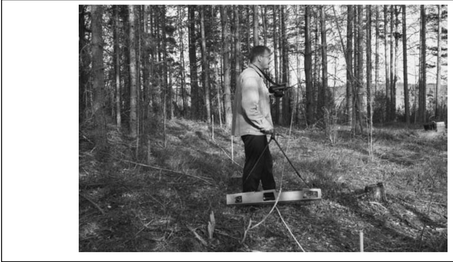
Kuva 1. 142918 Slingram-mittausta tehdään ensimmäisellä tutkimusalueella. Kuvassa Rauno Vaara. 9.5.2006
