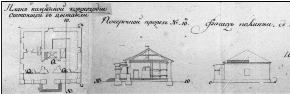
Kuva 75 Pohjapiirustus, poikkileikkaus ja julkisivukuva sitadellin vahtituvasta vuodelta 1804. Karttalähde: MV/RGVIA 349:12:1923
