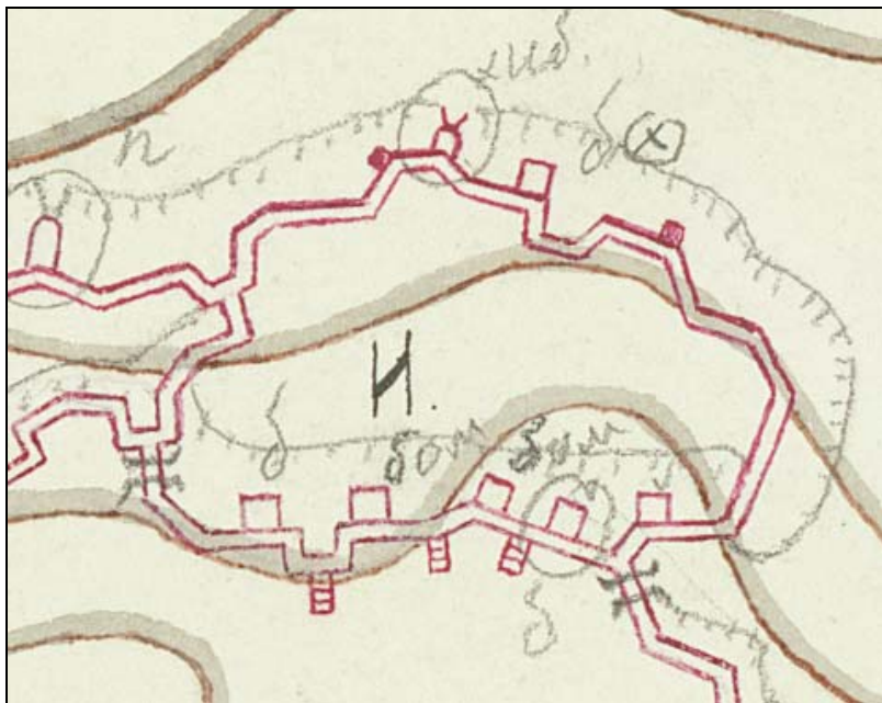
Kuva 7 Yksityiskohta puolustusaseman I:19 pohjoisosasta. Mahdolliset pomminheitinten asemat on merkitty kirjaimilla бом. Niiden edustalle on merkitty kolmet portaat. Suojahuoneet on merkitty kirjaimella б ja konekivääriasema kirjaimella n. Keskellä ylhäällä tähystysasema. Yksityiskohta venäläisestä sotilaskartasta. Kansallisarkisto, sotilaskartta 228.
