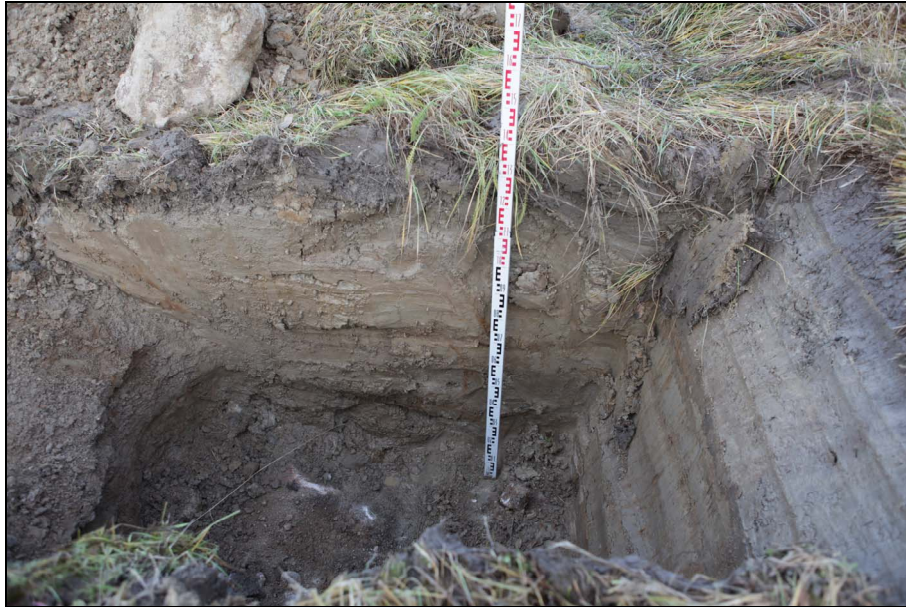
Kuva 5. Esimerkki ojan 1 koillisprofiilista ojan kaakkoispäässä. 10-20 cm paksun muokkauskerroksen jälkeen alkaa puhdas savi, jonka alla n. 1,4 m syvyydessä on kivisempää moreenia. Lounaasta. Kuva: W. Perttola/Museovirasto.
