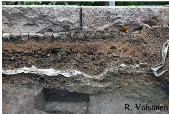
Kuva 4. Koeojan eteläprofiilin lounaispäätty. Profiilissa esillä pihakiveys asennushiekkoinen sekä sen alla ollut sepelitäyttökerros. Suodatinkankaan alla sorakerros, jonka alta tuli esille tumma niittykerros. Oikeassa reunassa johto- tai kaapelikaivantoon liittynyt savikerros. Profiilin edessä on koekuoppa 2.
