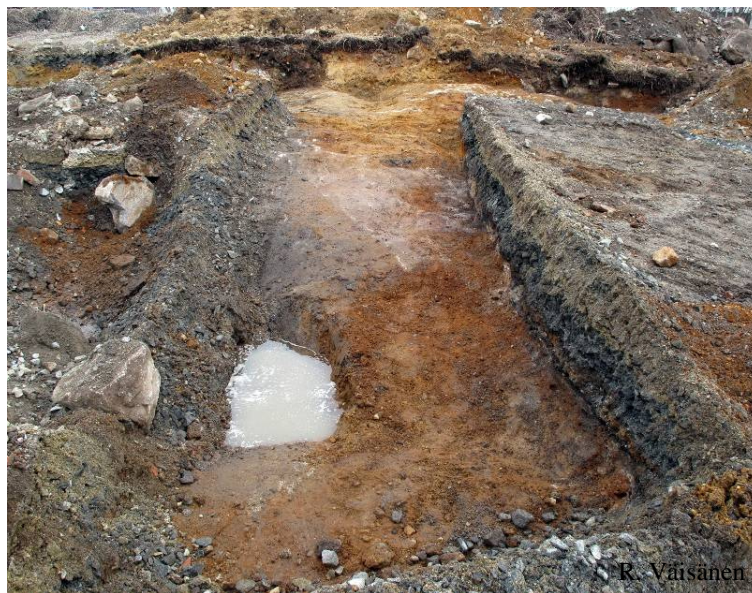
Kuvat 19. Koeoja 4. Peruskallio laskee selvästi kohti tontin länsilaitaa, ja kallion väleihin jäävät kolot ovat täyttyneet karkealla hiekalla. Taustalla näkyy koeoja 3. Kuvat otettu koilliseen.
