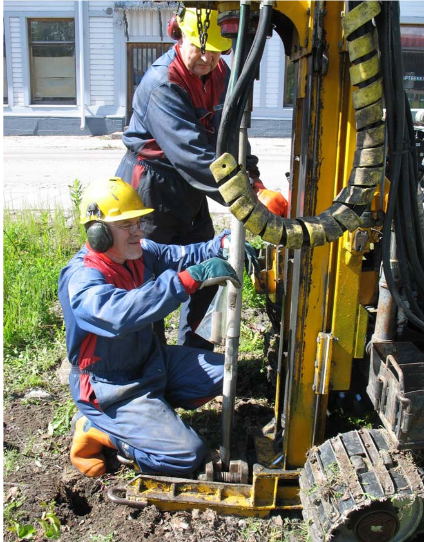
Kuva 7. Läpivirtaterällä kairattu näyte tuli ulos näytteenottoterän sivusta ja kerättiin muovipussiin. Pussista näyte siirrettiin näytepöydälle tutkittavaksi. (kuva :14)
