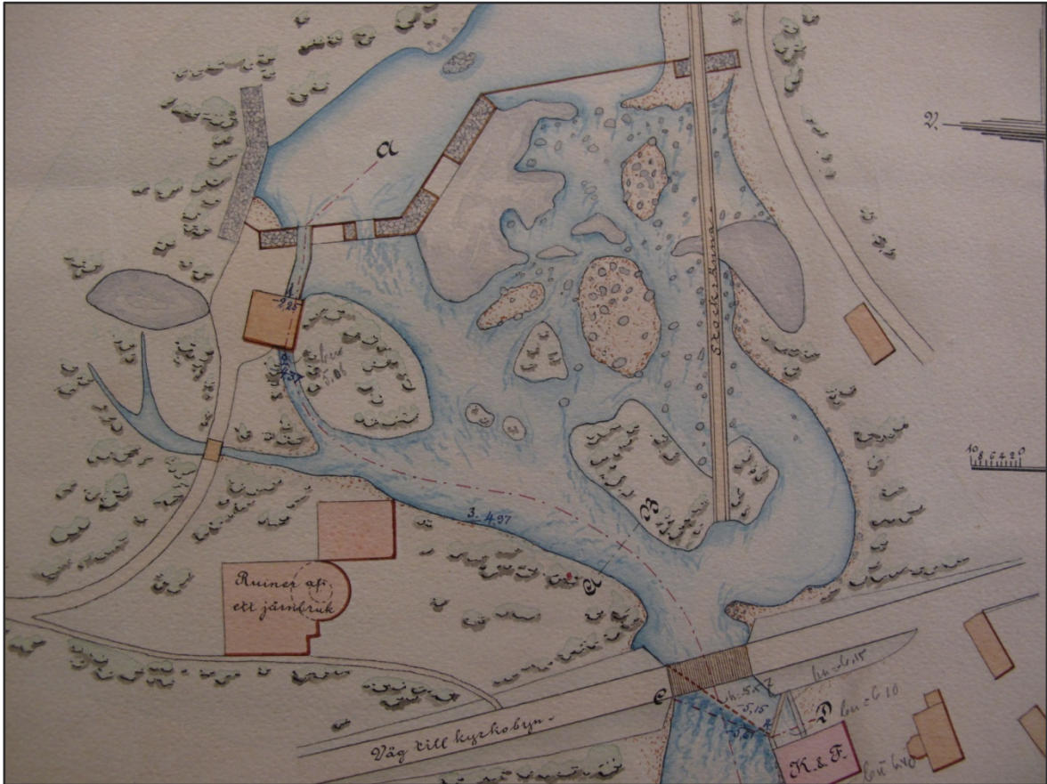
Kartta 3 Vuonna 1891 laadittuun karttaan on merkitty rautaruukin raunioituneet rakennukset. Kartan oikeassa alakulmassa ovat viilatehtaan rakennukset. 21
