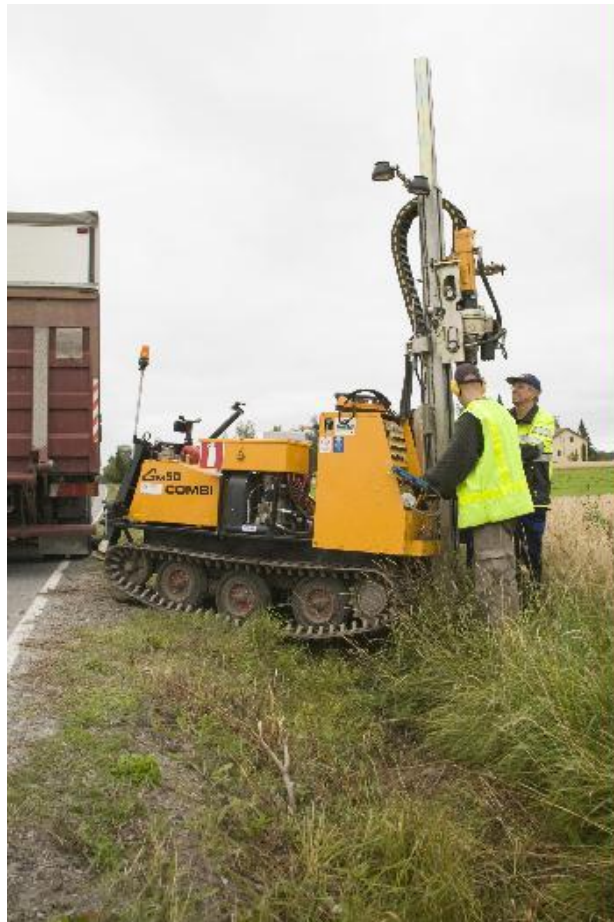
Kuva 3. Monitoimikairausvaunu työssään. (kuva Marika Tamminen / Vapriikki)
