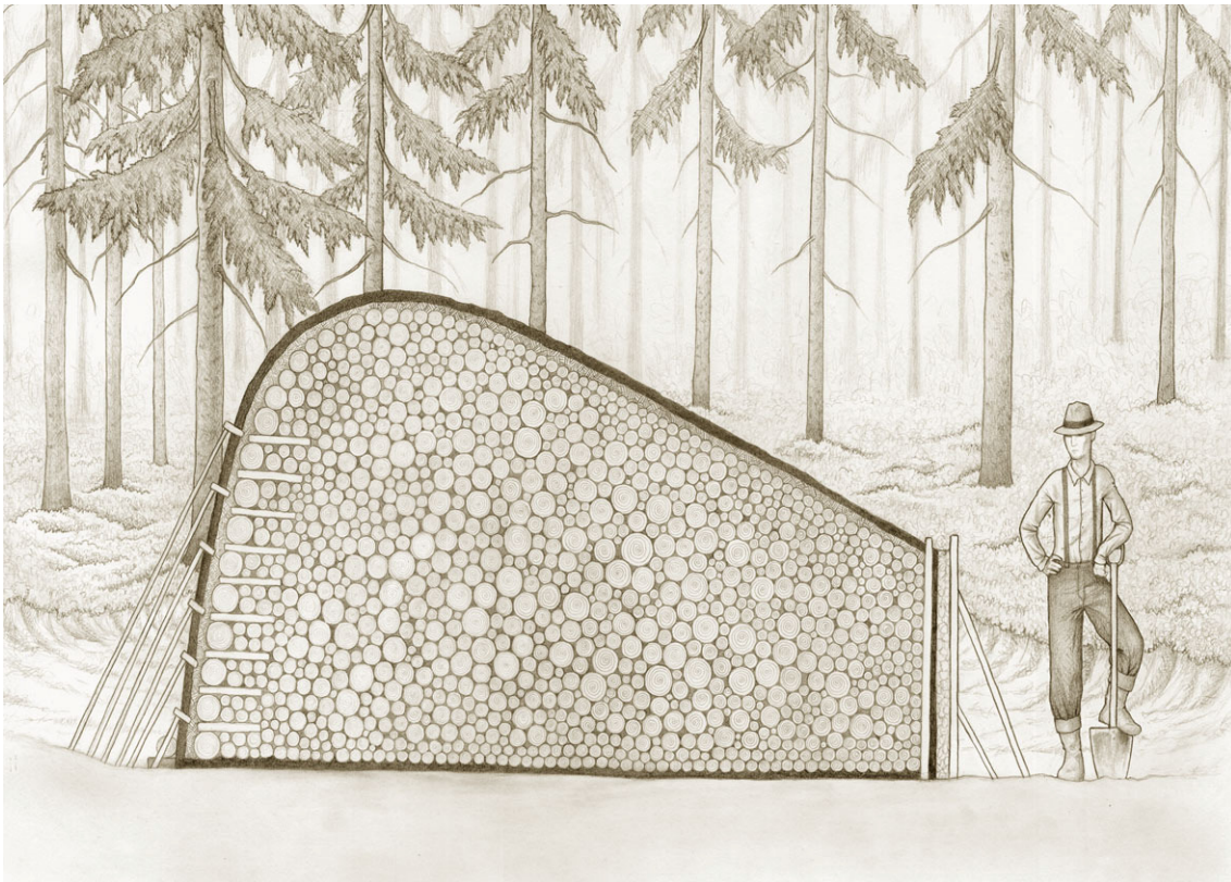
Kuva 5: Lamamiilun poikkileikkaus (Bergroth 1885:35 mukaan). Kuva: M. Lagerroos/KyAMK.
