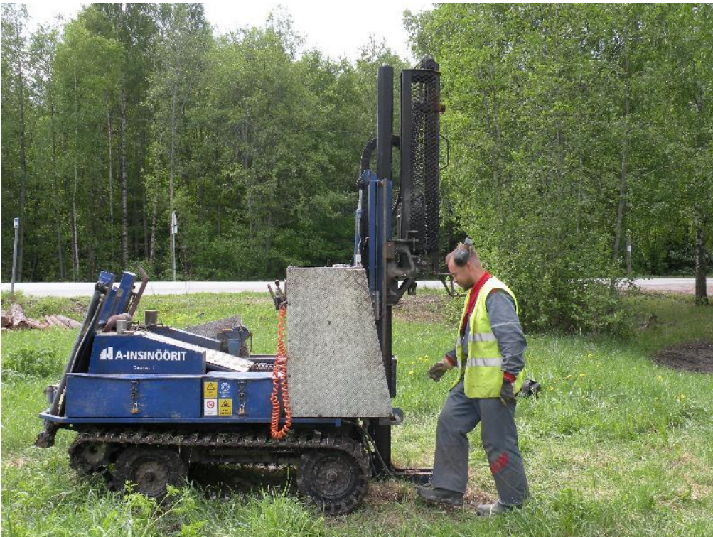
Kuva 6. A-insinöörien Geotest kartoittamassa maaperää puristinheijarilla tutkimusalueella C. Kuvattu pohjoisesta. (089[1428]), 26.5.2010, Kirsi Luoto.
