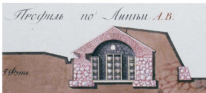
Kuva. Ruutikellarin pohjakaava ja poikkileikkaus. (Kartta vuodelta 1792, RGVF.F.3L.op.26.D.1716.s.8. Kyhika)
