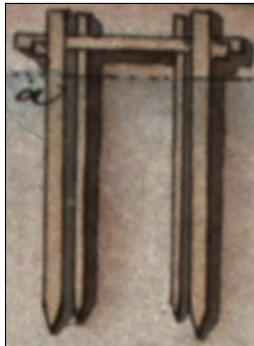
Kuva 23. Aallonmurtajan puinen keskirakenne. Yksityiskohta venäläisen insinöörikomennuskunnan kartasta (VIK Lappeenranta nro. 92).
