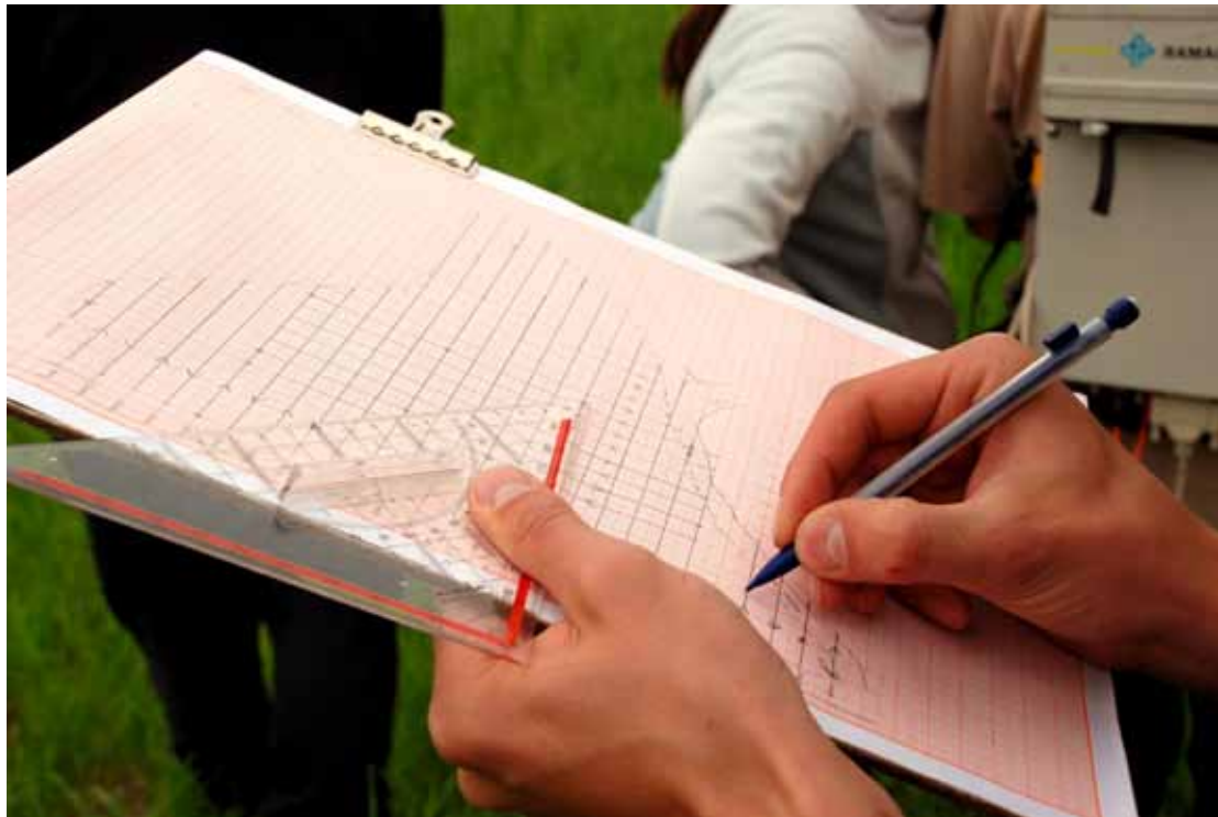
Kuva 8. Maatumkaluotauksessa kuljetut luotauslinjat merkittiin maastossa luotaustiedostojen nimien kera millimetri-paperille laadittuun karttaan. Valokuva: Juhana Ahlamo 2009.
