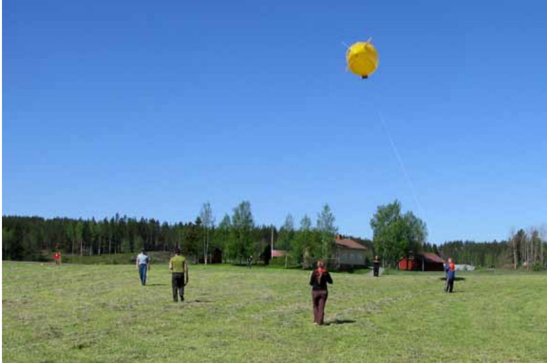
Kuva 7. Matalailmakuvausta kokeillaan Nääsinnokan länsi- ja koillisalueen peltoalueella toukokuussa 2009. Heliumpalloon kiinnitetyllä ja suoraan alas suunnatulla kameralla kuvataan Kuustontielle vastakkaista luode-kaakko-suuntaista linjaa. Valokuva: Juhana Ahlamo 2009.
