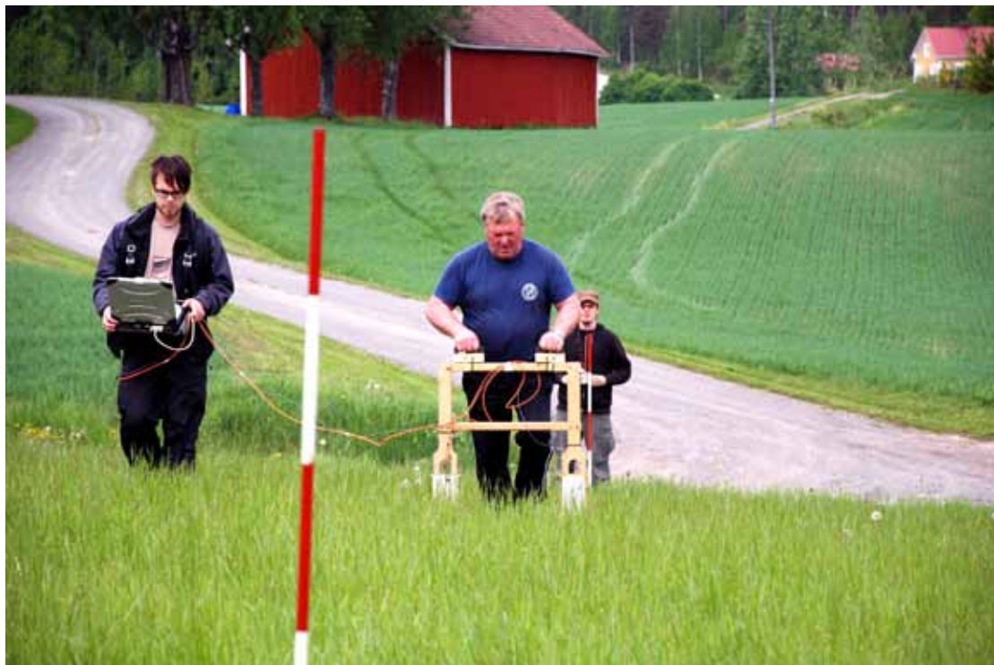
Kuva 8. Maanomistaja Arto Ålenius kuljettaa maaluotausantennia luode-kaakko -suuntaisella ja mittausavoin merkityllä luotauslinjalla kesäkuussa 2009. Maaperägeologian opiskelija seuraa luotauslinjalta kertyvää aineistoa tietokoneelta (vas.) arkeologian opiskelija Toni Paukun (oik.) tarkkaillessa kuljettavan linjan suuntaa. Valokuva: Juhana Ahlamo 2009.
