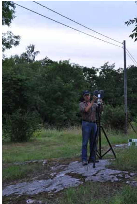
Kuva 27. Kari Uotila (Muuritutkimus ky) asettamassa Faro 3D -laserkeilainta mittausvalmiuteen houruinhuonetontin kaakkoisosan kallioalueella. Mikko Helminen. TYA 31:2.
