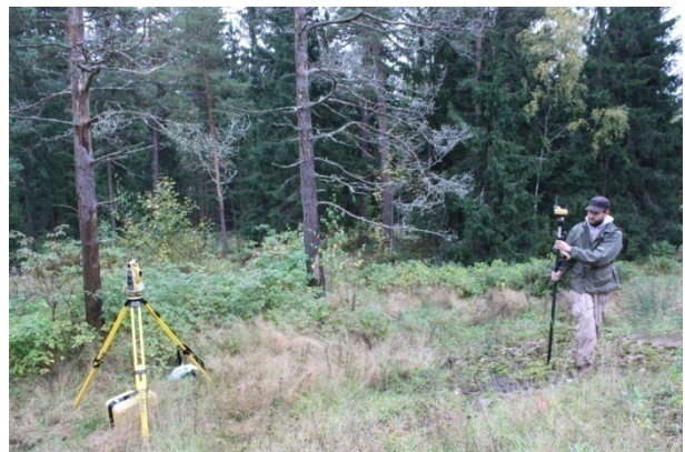
DG2710:14. Tukikohta XXIII:7 itäosa, mittausta. Mikko Suha kartoittaa robottitakymetrillä. Kuva Petro Pesonen.
