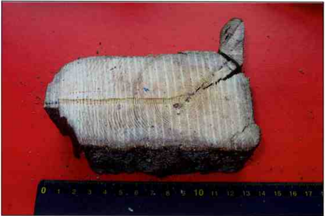
Kuva 9. Dendrokronologinen ajoitusnäyte FIU6009. Liitossalvos kuvan oikeassa yläkulmassa.
