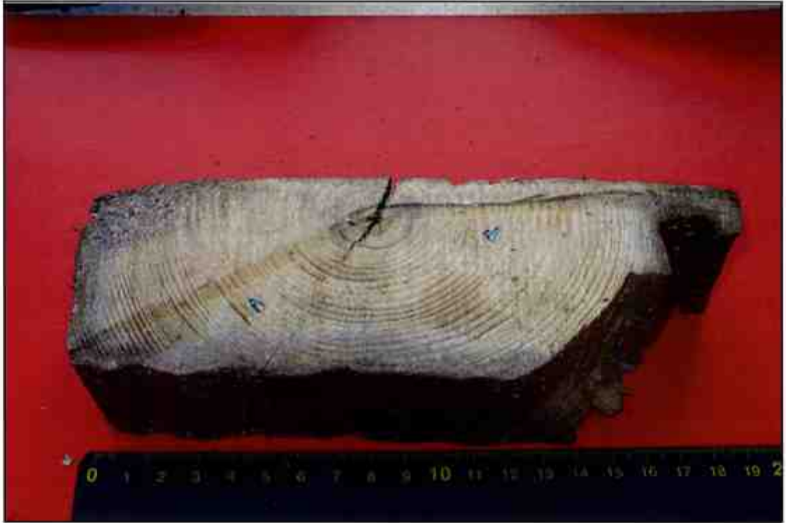
Kuva 5. Dendrokronologinen ajoitusnäyte FIU6005. Liitossalvos kuvan oikeassa reunassa.
