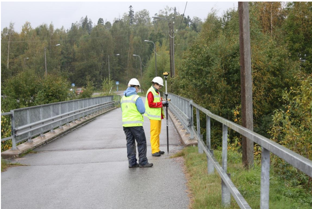
DG2706:3 Maija Helamaa ja Tuija Väisänen mittaamassa kiintopistettä 3 Kauklahdenväylän pyörätiellä. S-N. Kuva Katja Vuoristo.
