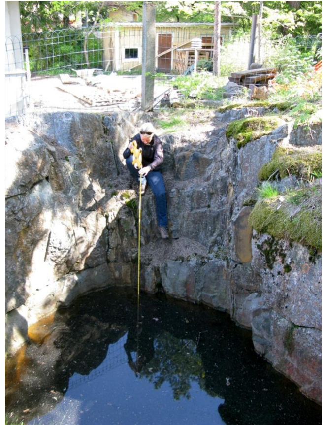
Kuva 7. Satu Koivisto mittaa vedellä täyttyneen kaivoskuopan 1 syvyyttä luodilla ja mitalla. Kuva: Katja Vuoristo/MV (DG2980:3).
