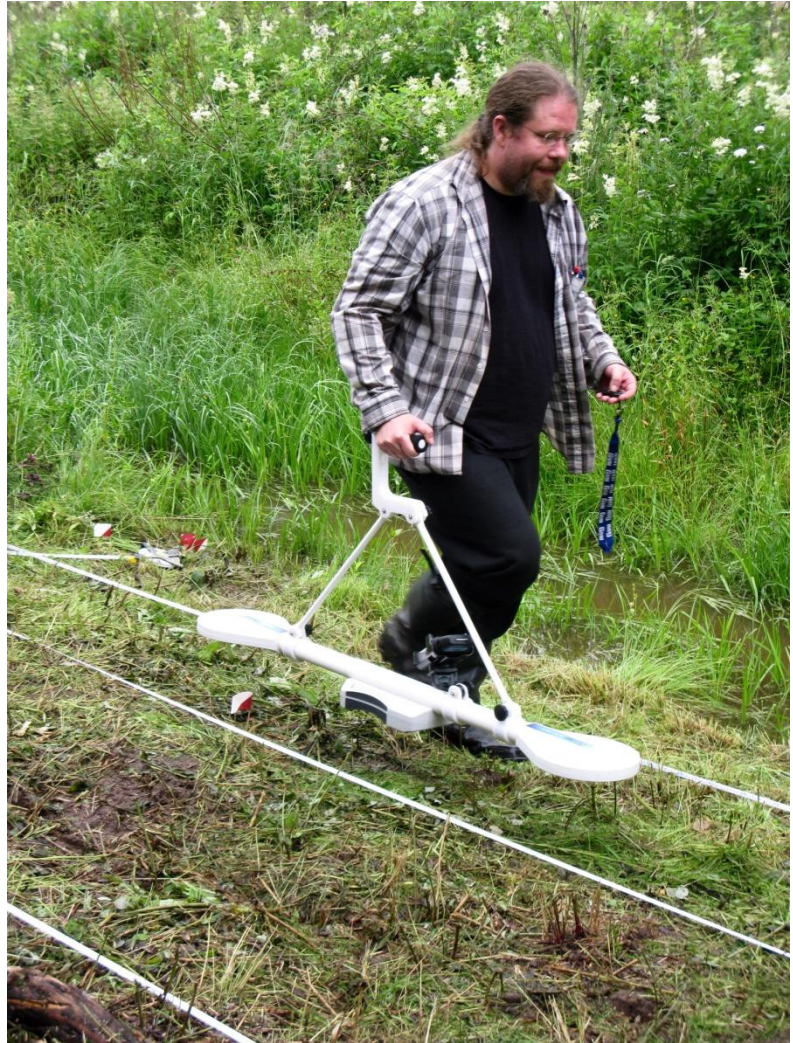
Kuva 8. Wesa Perttola mittaamassa slingram-laitteella Lamminojan reunaan. Kuvattu lounaaseen. Kuva: Satu Koivisto 2012.
