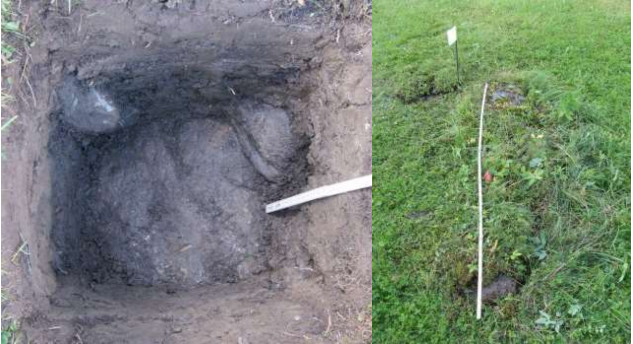
TYAdigi 39. 94 ja 95. Vahosten entisen pappilan pihamaalle kaivettu koekuoppa, jonka pohjassa näkyy kallio. Tumma maa on märkää, likaista savimaata. Oikealla koekuoppa peitettynä ja sen vierellä sijainnut kivirivi. Kuvat H.-M. Pellinen.
