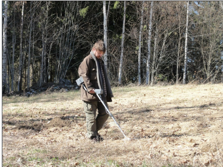
T Sepänmaa tutkii kaapelilinjaa metallinpaljastimella.
