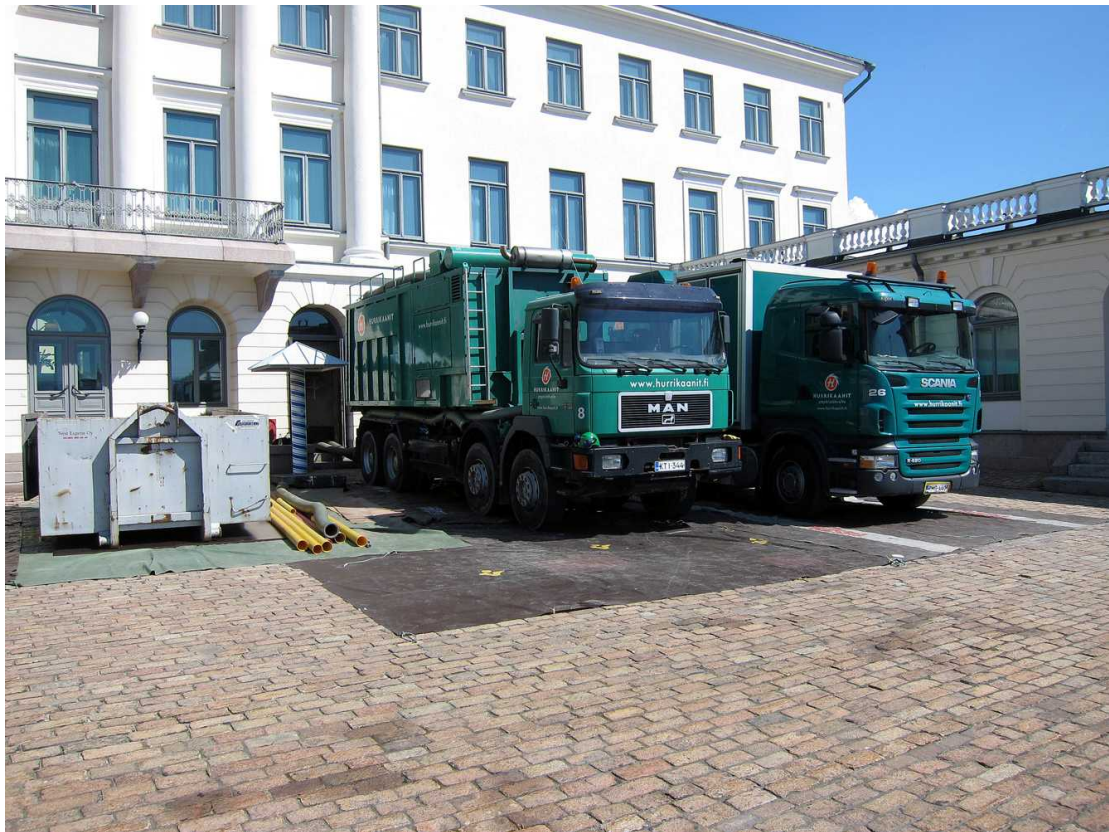
Kuva 232. Etupiha. Imuautoja hiekan poistamiseksi kellareista. Kuvaussuunta NE. 28.6.2011.
