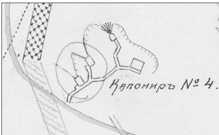
Kuva 23 Kohde II:6 eli kaponieeri nro 4. Vasemmalla on kaksi suurilla ampumasektoriraivauksilla varustettua tuliasemaa, ylhäällä valonheitinasema ja oikealla suojahuone. Kaponieerin vasemmalla puolella on piikkilankaeste. Kuva on osa venäläisestä linnoituskartasta. Sotilaskartta 228, Kansallisarkisto.
