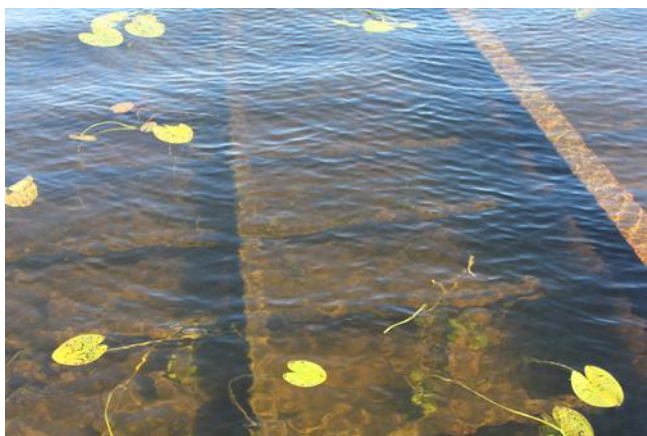
Kuva 2. Oikealla ylempänä rautainen sikoköli. Keskellä pituussuunnassa jäykistäjä ja vaakasuunnassa puiset pohjatukit. (AKMA201307: 7)
