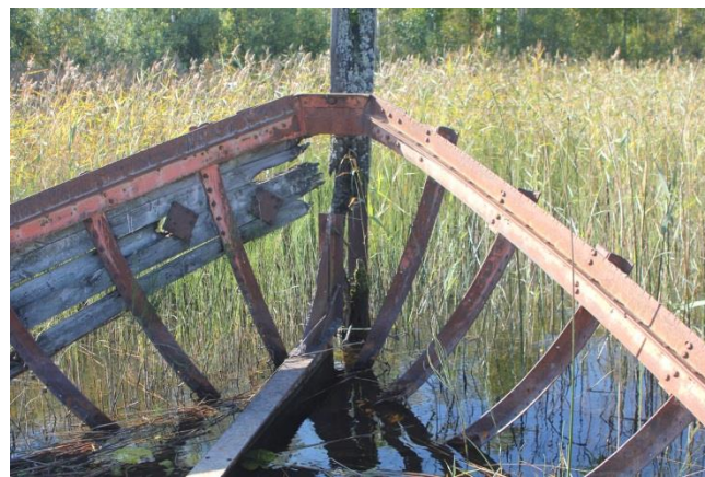
Kuva 3. Proomun keula ja rautaiset kaaret. Vasemmalla puolella osa puuverhoilusta, jossa on kaksi rautaista korjauspaalaa. (AKMA201307: 10).
