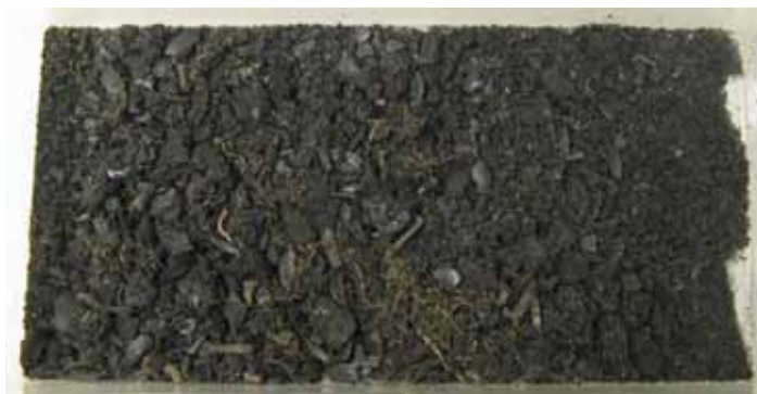
Kuva 1. Siiviläsarjan avulla erikokoiset hiilenpalat ja kasvijäänteet saadaan erotettua toisistaan. Astian vasemmassa reunassa ovat 1 mm siivilän aines ja oikealla on 0,25 mm siivilän aines. Näyte 1 kuivumassa.
