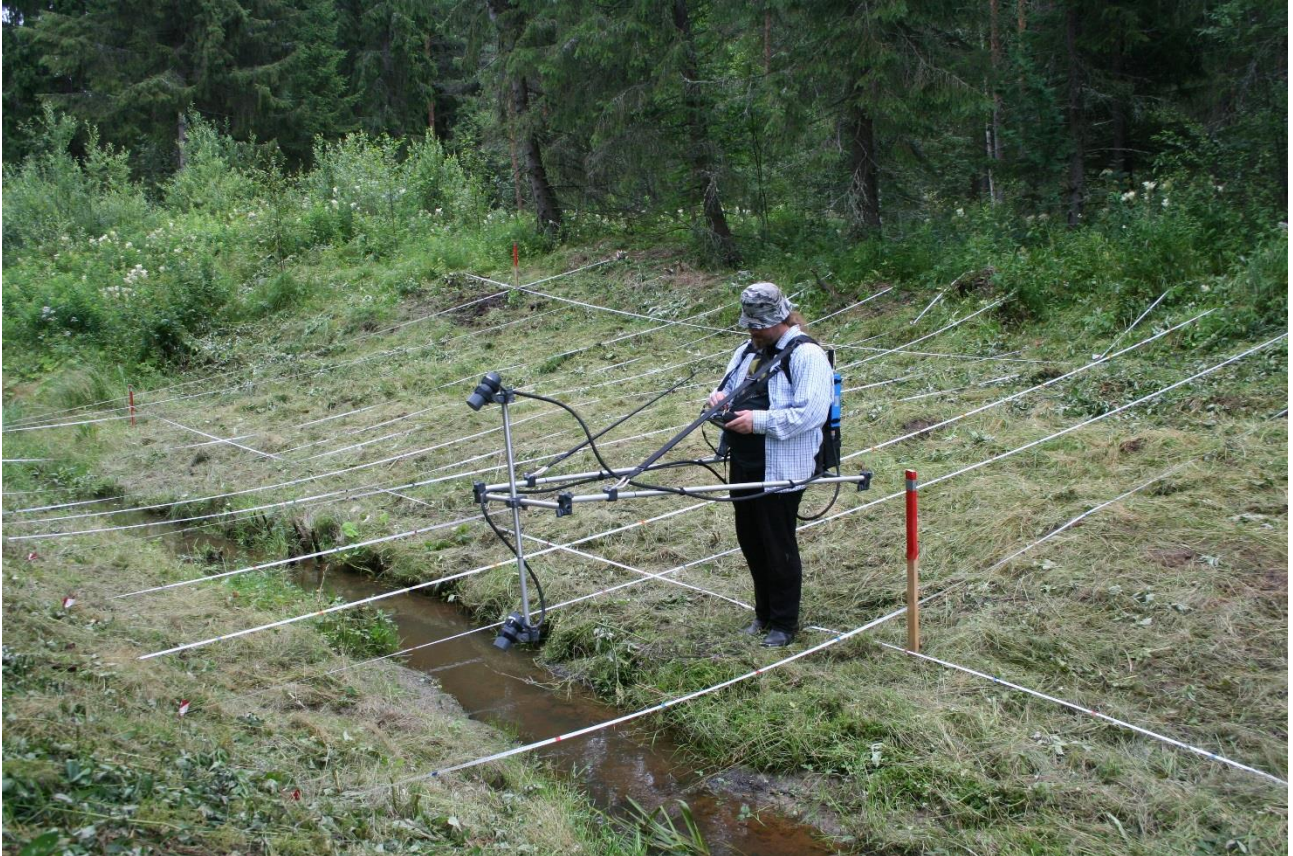
Kuva 7. Wesa Perttola mittaa magnetometrillä Lamminojan itäistä reunaa. Poikittaiset tutkimuslinjastot ulotettiin ojassa pilkottavien puolöytöjen päälle, jotta saataisiin tietoa siitä, aiheuttavatko ne muutoksia laitteen mittausarvoissa. Kuvattu itäkoilliseen. Kuva: Satu Koivisto 2013.
