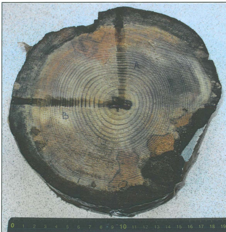
Kuva 4. Dendrokronologisessa ajoitusnäytteessä FIO3413 sydän- ja mantopuun raja näkyy lahonneisuuserona puun pintaosassa.
