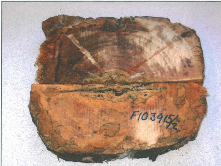
Kuva 6. Dendrokronologinen ajoitusnäyte FIO3415 lahonneesta hirrestä, jossa kuitenkin on kahden-kolmen senttimetrin paksuinen kerros mantopuuta säilyneenä.
