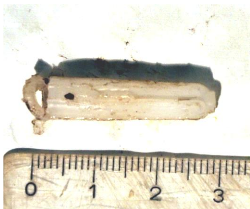
Kuusikulmainen vaalea muovin-kappale, jonka kahdella sivulla matalat urat. Toisessa päässä on pyöreä lyhyt varsi, toinen pää avoin ja reuna puoliksi murtunut irti. Sisältä ontto.
