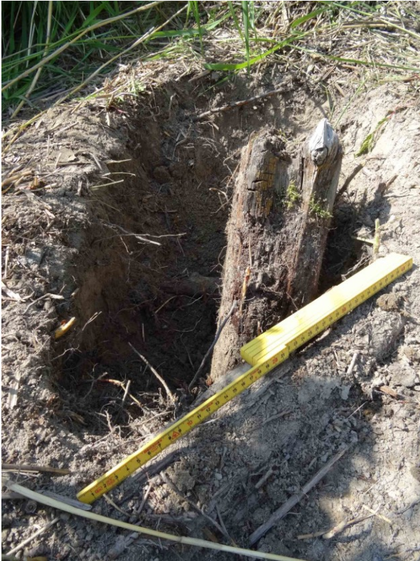
Kuva 12. 40 x 40 cm kokoinen koekuoppa kaivettiin taittomitan alla olevan kylkilankun ulkopuolelle. Puuosa liittyy todennäköisesti rakenteeseen puulajin ja ulkonäön perusteella.
