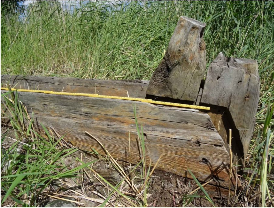
Kuva 10. Steevin kaksi osaa on liitetty yhteen puutapilla. Rakenne on limisaumainen ja osat on liitetty toisiinsa rautanauloilla ja puutapeilla.
