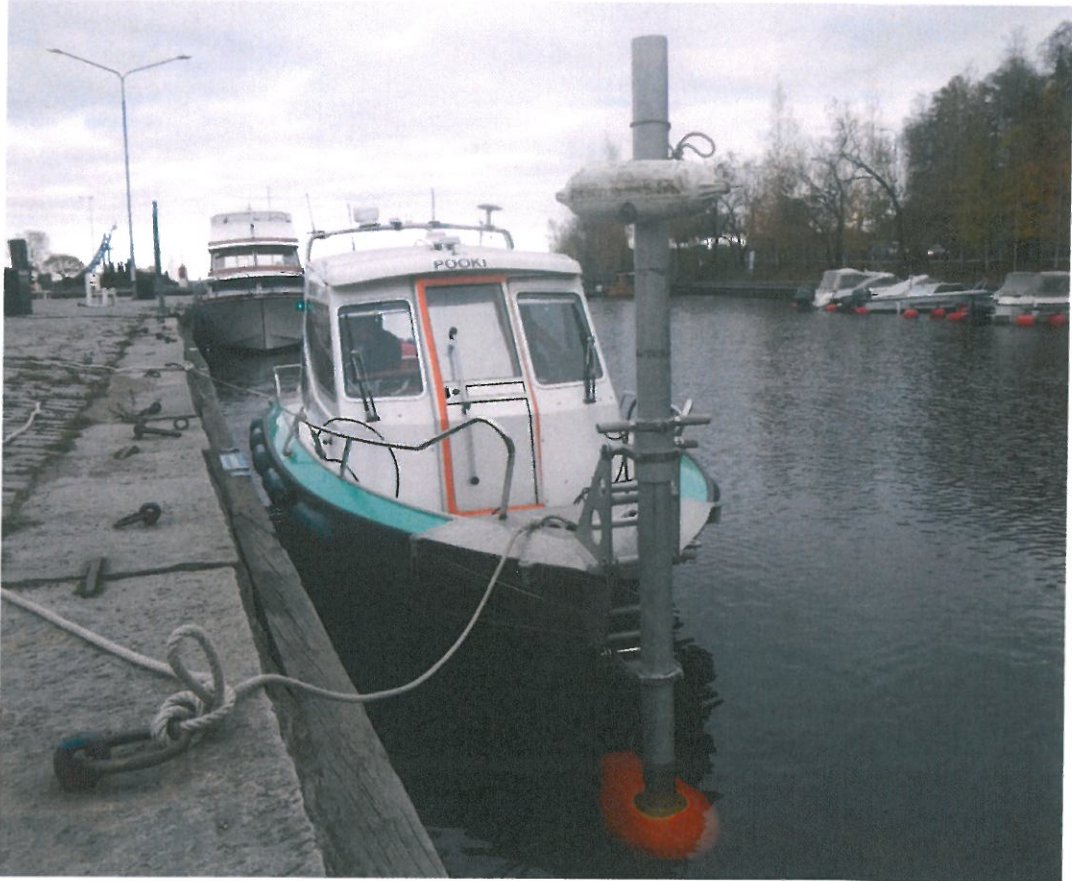
Kuva 2/Tutkimusvene Pooki. Keulassa matalataajuusluotauslaitteisto
